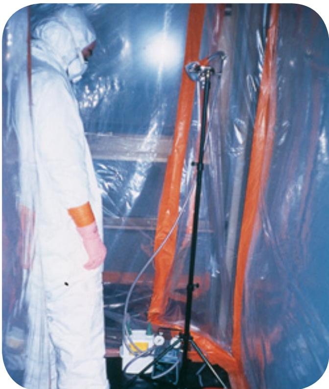
*Matériel de prélèvement d'atmosphère constitué d'une pompe et d'une tête de prélèvement.*
