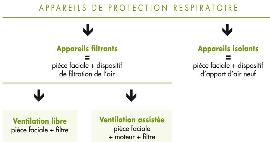
**Les appareils filtrants** anti-poussières susceptibles de pouvoir être utilisés face à différentes situations d'exposition à l'amiante peuvent être, par ordre de niveau de protection croissant :
