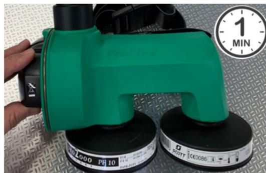
Démarrez le moteur les filtres fixés, laissez le moteur fonctionner pendant 1 minute avant de fixer le tube indicateur de débit d'air AFI
