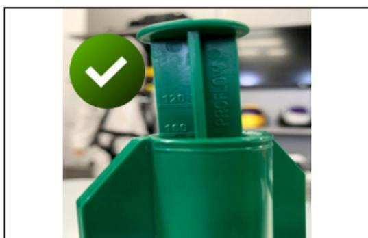
La lecture se fait avec l'indicateur de débit d'air en position verticale. Si l'indicateur est au-dessus de la marque 160, le système peut être utilisé.
