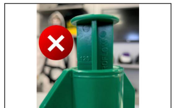
Si l'indicateur est en-dessous de la marque 160, assurez-vous que les filtres soient propres. Puis, laissez le moteur fonctionner pendant 5 minutes supplémentaires avant de vérifier à nouveau.
