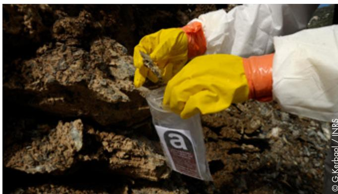
*Géologue effectuant un prélèvement de roche en vue d'une analyse au microscope*
