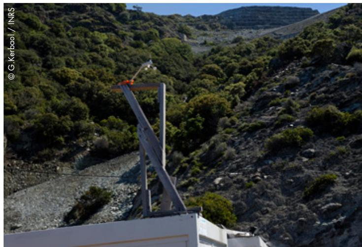
Station météorologique sur le toit de la base sanitaire permettant de vérifier l'orientation et la vitesse du vent
