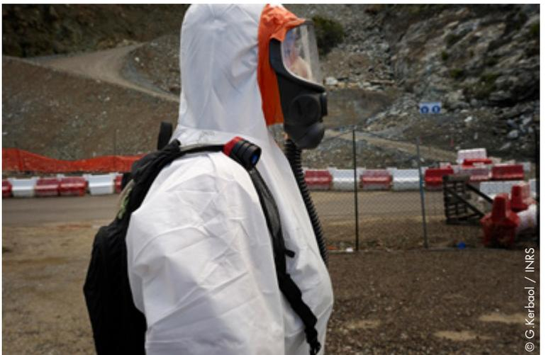
Conducteur d'engin équipé de protection respiratoire, engin équipé d'un système de filtration et de pressurisation de l'air
