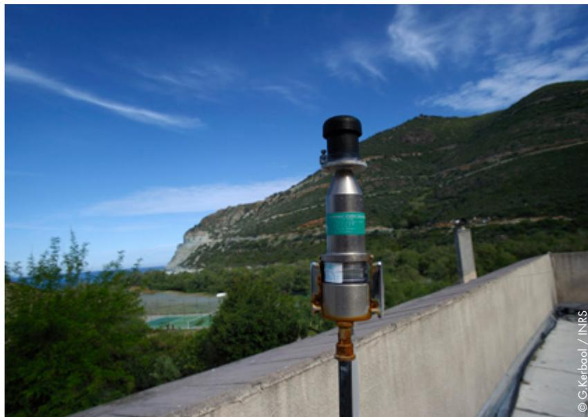
*Tête de prélèvement pour le contrôle de la qualité de l'air ambiant*
