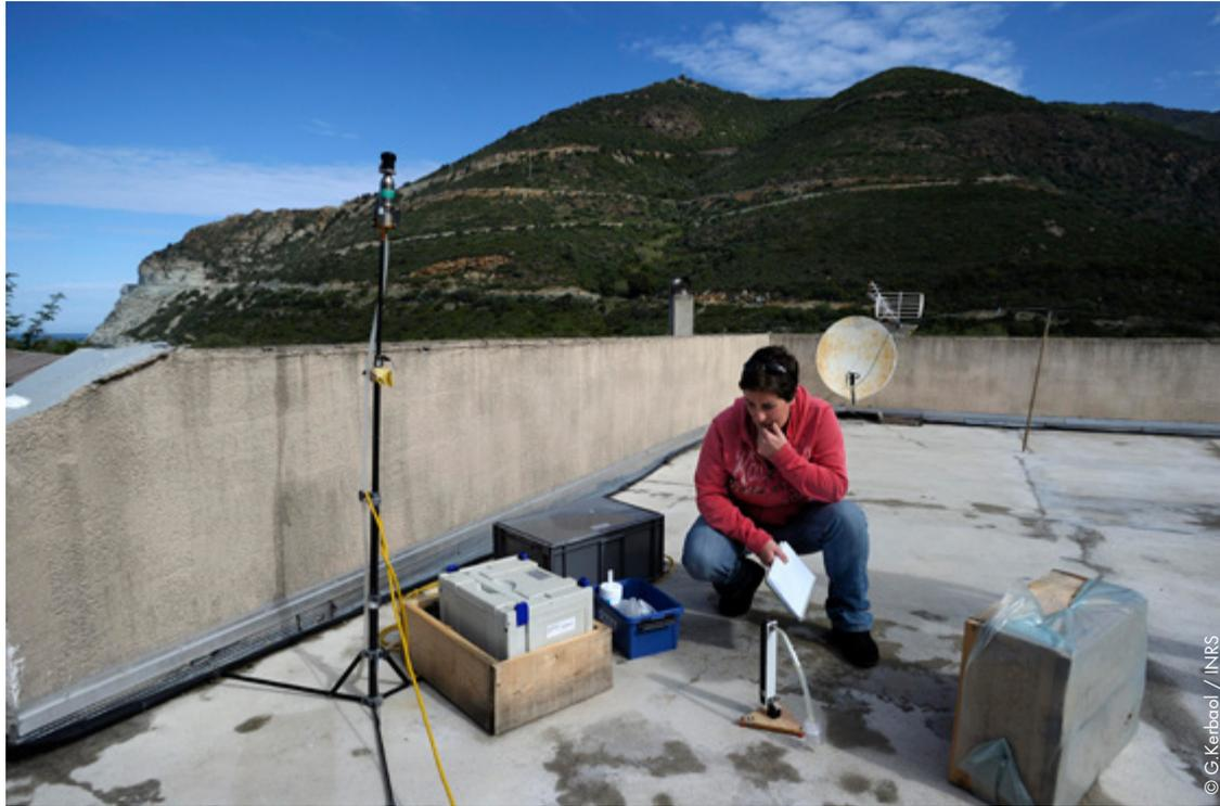
*Matériel pour le prélèvement d'air ambiant (tête de prélèvement, pompe, débitmètre pour la vérification de la pompe)*
